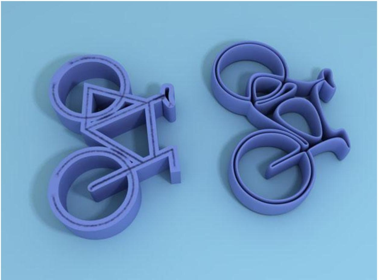
Рис. 6.20. Слева - исходная модель, справа - после применения модификатора MeshSmooth (Сглаживание)
