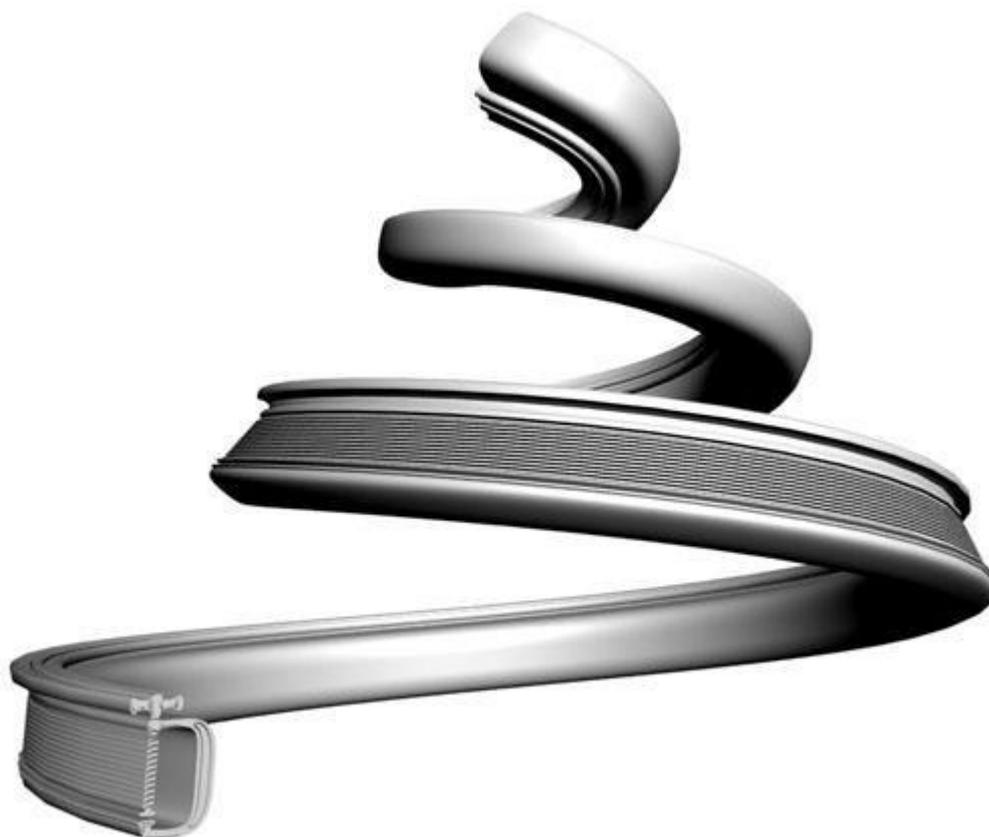
Рис. 5.9. Поверхность, созданная в результате применения модификатора Sweep (Выгнутость) к сплайну Helix (Спираль) с использованием в качестве профиля сплайнового текста
