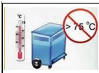
Работа сварочного агрегата разрешена при нагреве отдельных частей (трансформаторов, подшипников, щеток и др.) до температуры не более 75°C.
