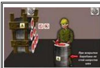
Для вскрытия барабана с карбидом кальция запрещается использовать искрообразующий инструмент. Место вскрытия необходимо смазать солидолом
