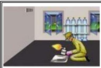
Помещения, в которых возможно скопление ГГ и ЛВЖ, перед началом огневых работ должны быть проветрены.
