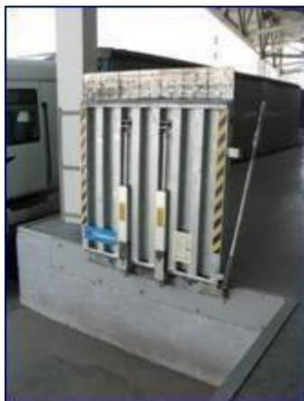
**Перегрузочные (откидные) мосты** используются для выравнивания поверхностей рампы склада и пола кузова автомобиля.
