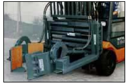
Захват с функцией опрокидывателя
