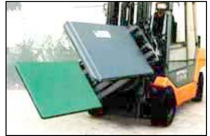
Двусторонний зажим с револьверной головкой с большой площадью захвата
