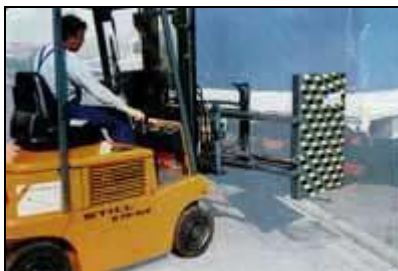
Зажим для крупногабаритных грузов с компенсатором
