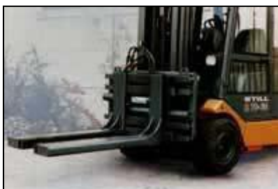
Зажим для крупногабаритных грузов с компенсатором
