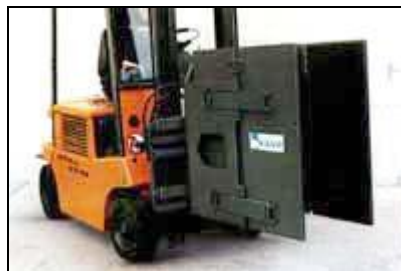
Захват для крупногабаритных грузов с большой площадью захвата. Применяется при погрузке "белой техники", например, холодильников.
