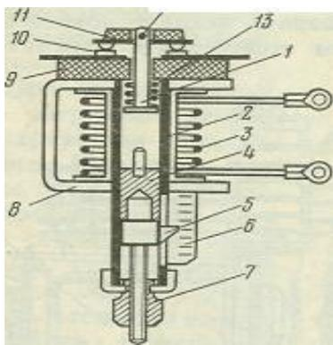
**Максимальное реле.** Максимальное реле, или реле максимального тока (рис 8), служит для защиты электродвигателя от повреждения при его перегрузке или замыкания.
