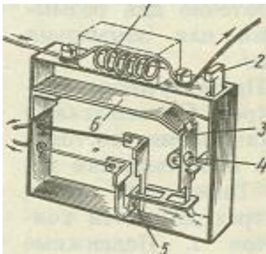
**Тепловое реле.** Тепловое реле служит для защиты электродвигателя от небольших, но длительных перегрузок, при которых ток двигателя на 10...20 % превышает номинальный. Реле срабатывает при определенной температуре, зависящей от тока в цепи двигателя.
